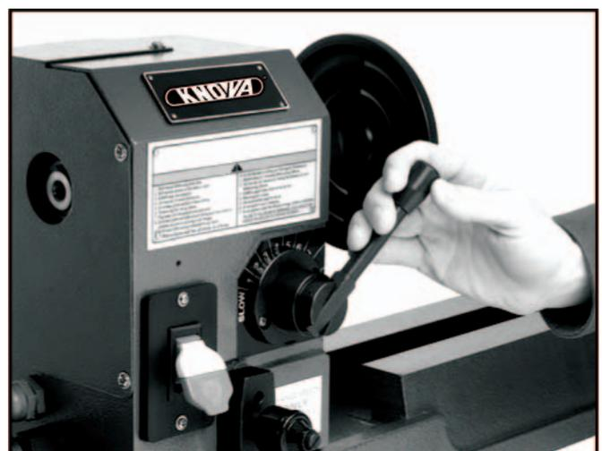
Figure 16. Ajustando el interruptor de velocidad
