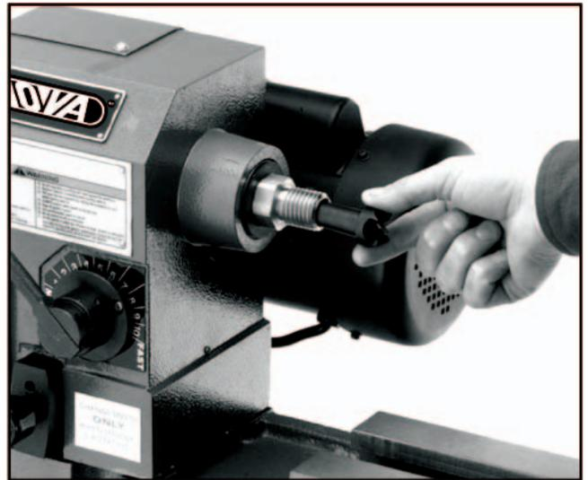
**Figure 8.** Instalando el engranaje central
