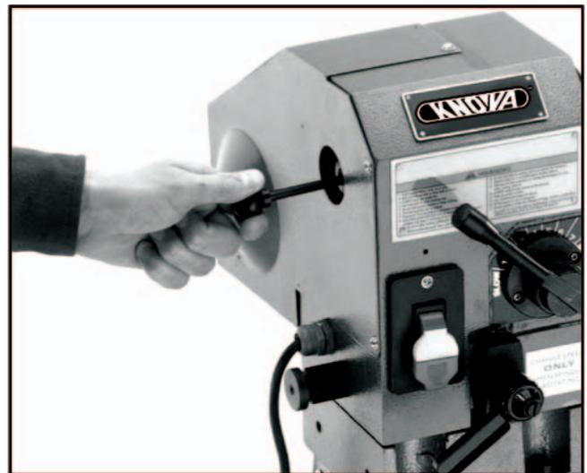
**Figure 9.** Removiendo el engranaje central
