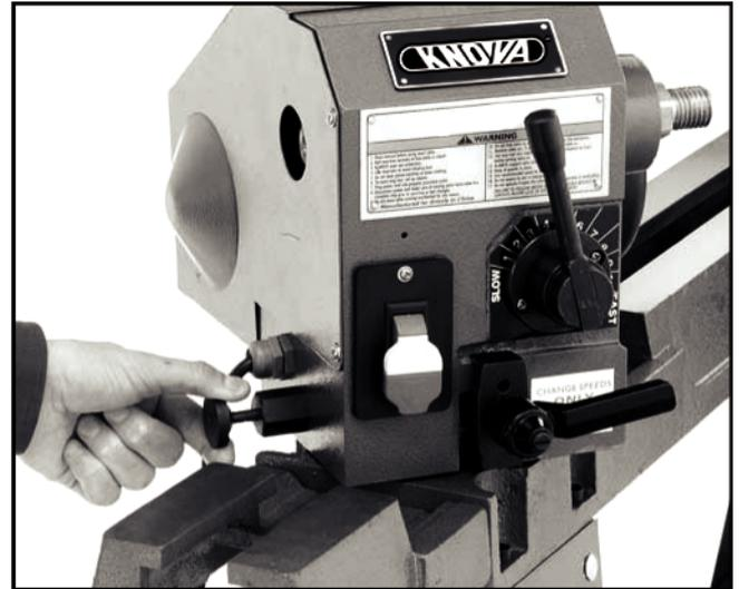
Figura 12. Ajustando el porta herramienta
