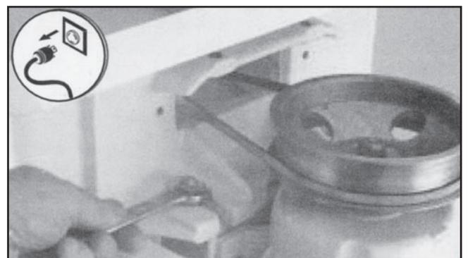
Figura 16. Ajuste de la tensión de la banda
