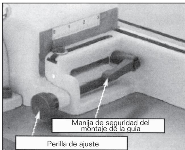
Figura 22. Manija de seguridad del montaje de la guía
